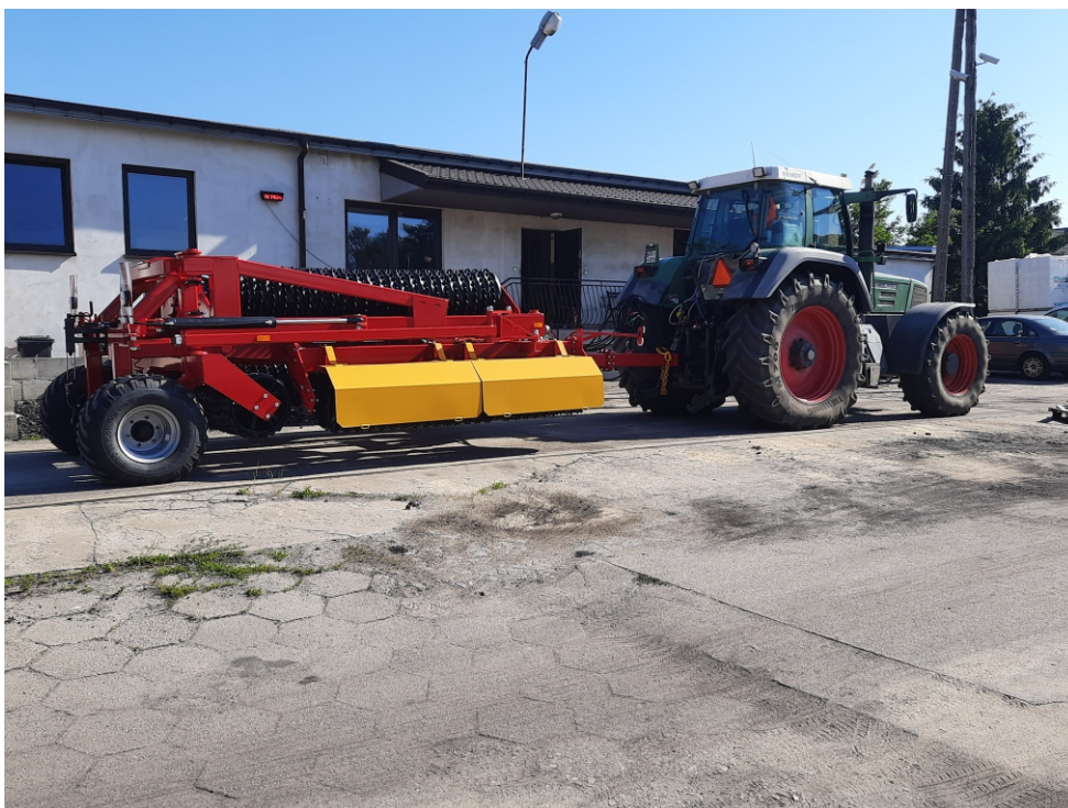
Zdjęcie nr 2. Osłona blaszana na zewnętrzne elementy maszyny.
