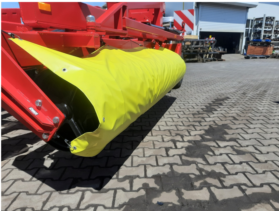
Zdjęcie nr 3. Osłona z plandeki na zewnętrzne elementy maszyny - strona prawa wału.
