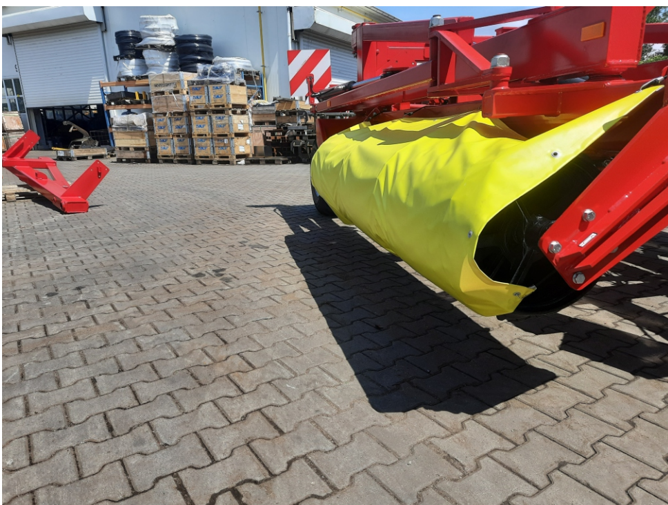
Zdjęcie nr 4. Osłona z plandeki na zewnętrzne elementy maszyny - strona lewa wału.
