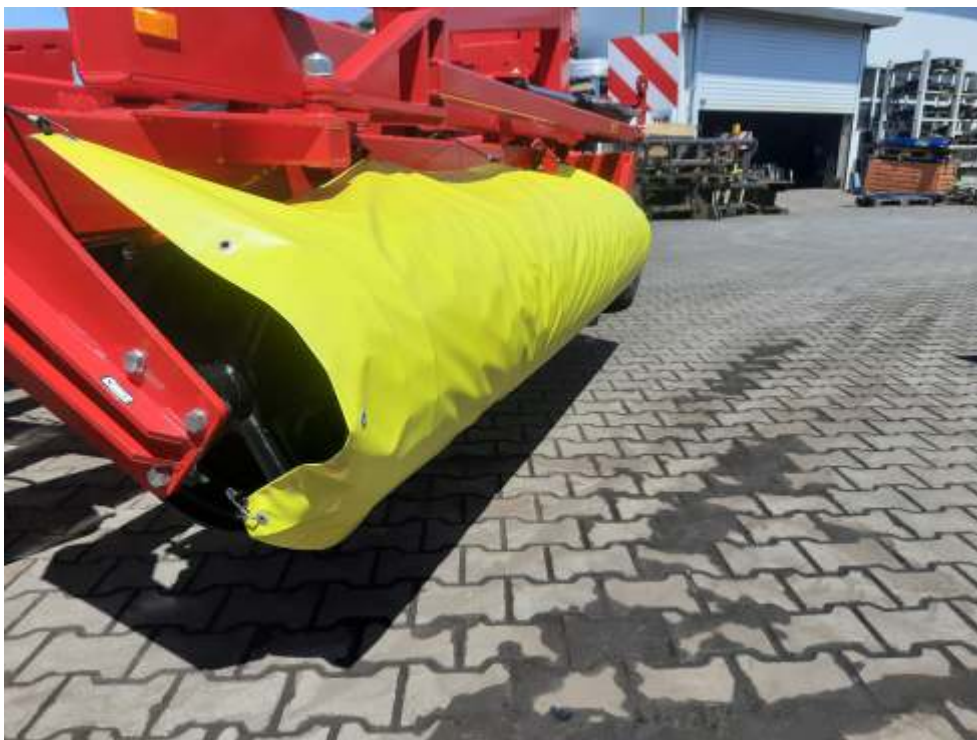
Zdjęcie nr 1. Osłona z plandeki na zewnętrzne elementy maszyny - strona prawa wału.
