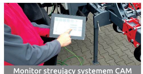
Automatyczne naprowadzanie sekcji na międzyrzędzia
