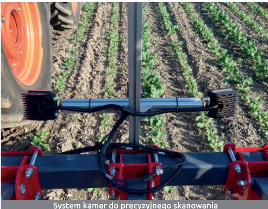
Automatyczne naprowadzanie sekcji na międzyrzędzia
